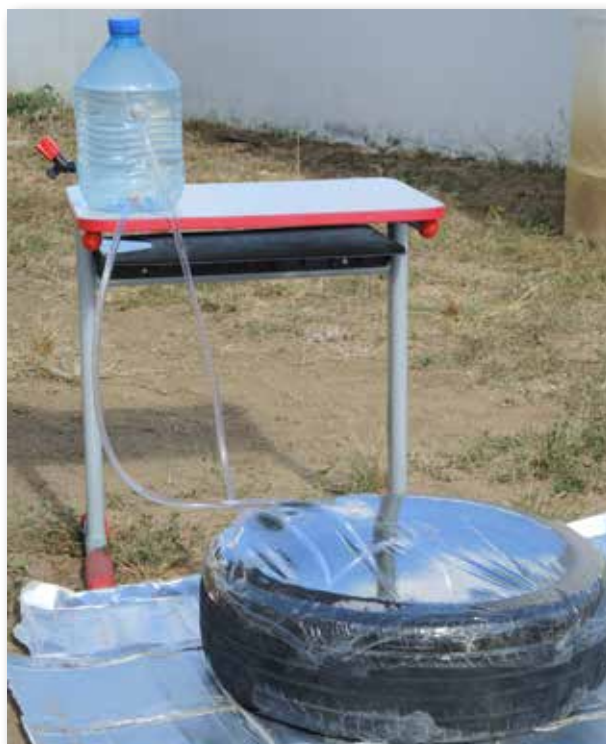
Aquecedor solar de água em Crateús
