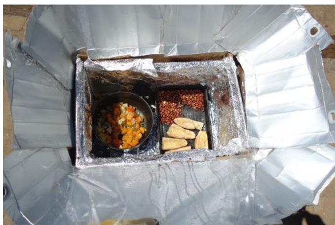
Forno solar aquece os alimentos só com a luz do sol, sem necessidade de fogão
