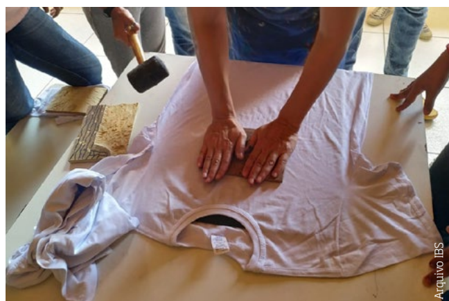
Entintando a matriz e a posicionando sobre a camiseta, pressionando primeiramente com as mãos.
