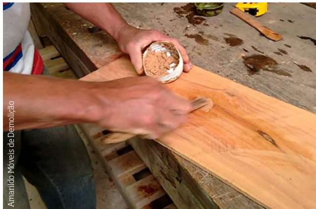
Pasta com cola de serragem para tapar buracos.
